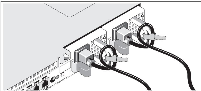
Dobre o cabo de alimentação do sistema em forma de laço conforme apresentado na ilustração e prenda-o com a tira fornecida.
