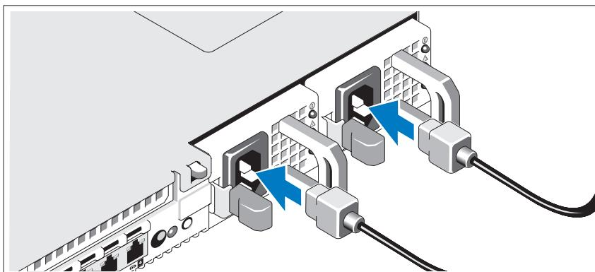
Connectez le(s) câble(s) d'alimentation au système et, si vous utilisez un moniteur, connectez son câble d'alimentation à celui-ci.
